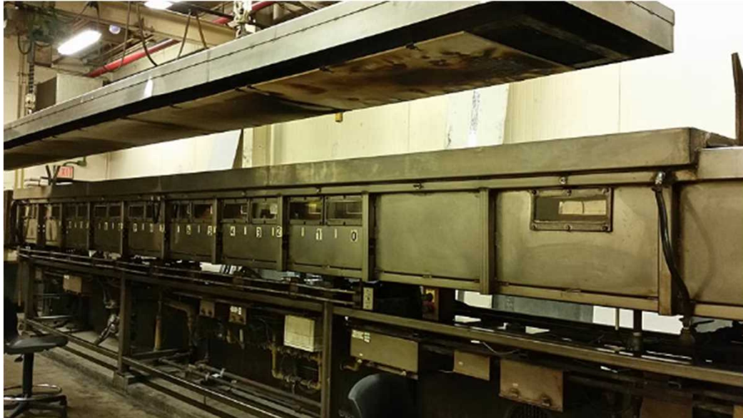
スタイナートンネル試験機（外観）
